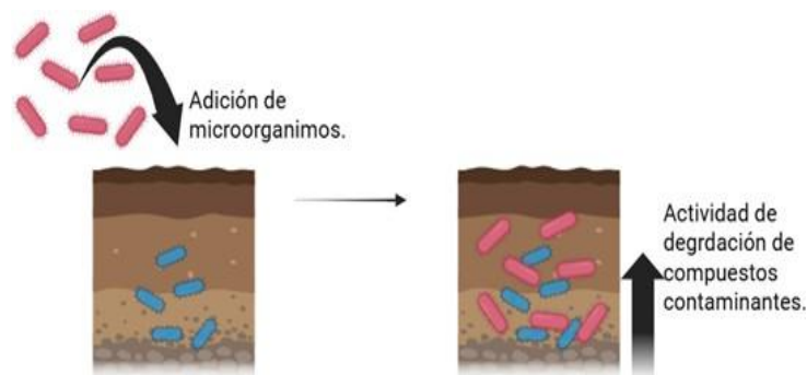
Figura 2: Mecanismo de bioaumentación: adición de cepas de microorganismos especializadas para mejorar la remediación.
